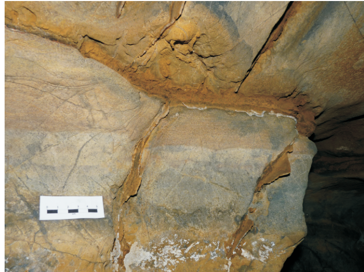
Foto 1. Aspecto geral dos calcários encaixantes exibindo a foliação metamórfica e um conjunto de fraturas preenchidas por argilominerais e calcita.
