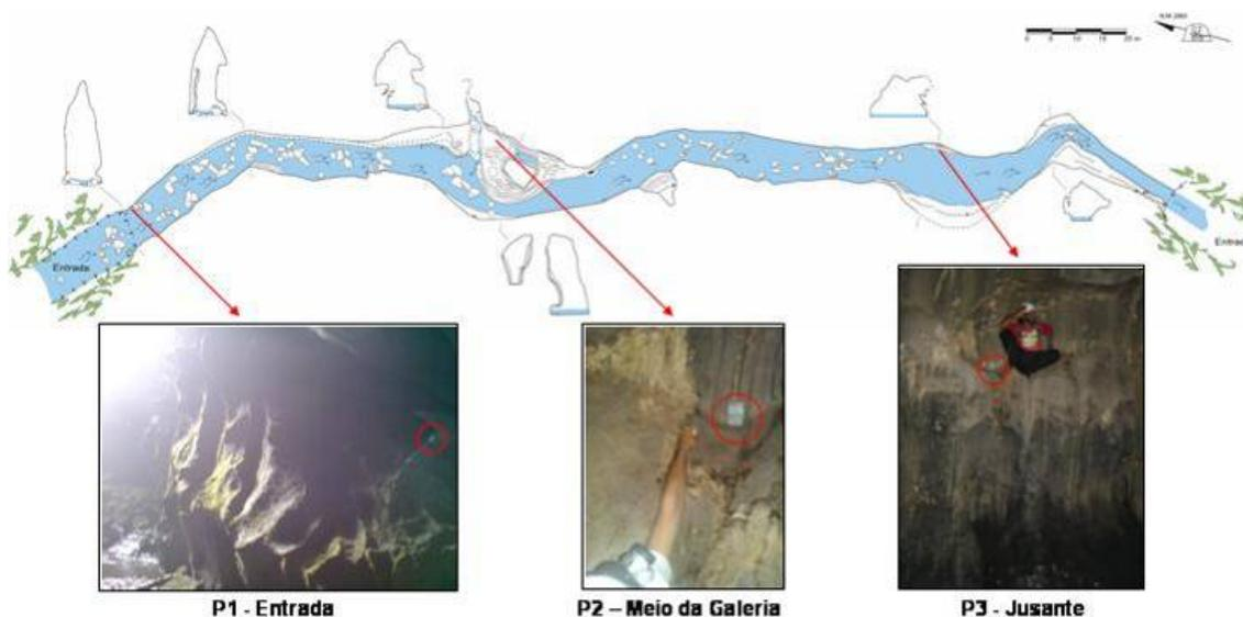
**Figura 275. Localização dos pontos de instalação dos termohigrômetros na caverna Água Sumida**
