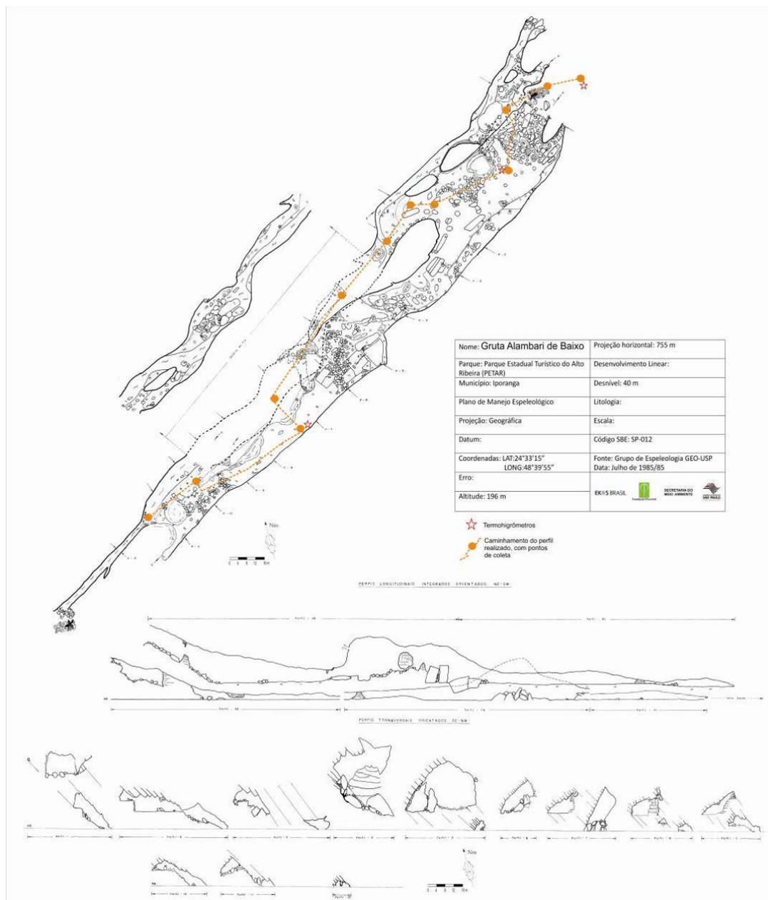
Figura 116. Planta baixa e corte da caverna Alambari de Baixo, com respectivos pontos de instalação dos termohigrômetros e caminhamento dos perfis realizados
