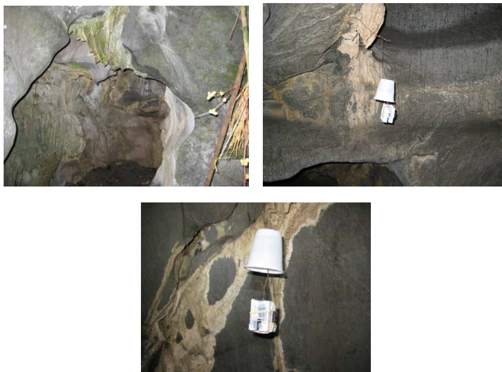
Figura 118. Foto dos termohigrômetros instalados na gruta do Tatu
