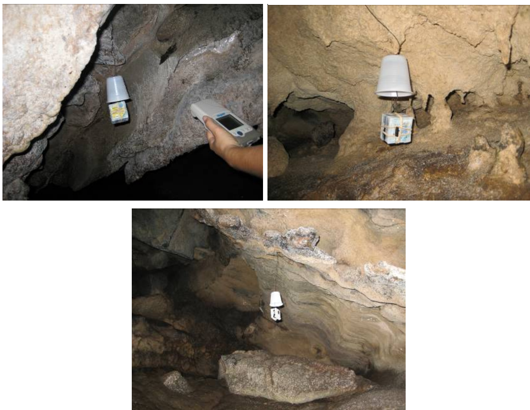
Figura 54. Localização dos termohigrômetros na gruta Jane Mansfield
