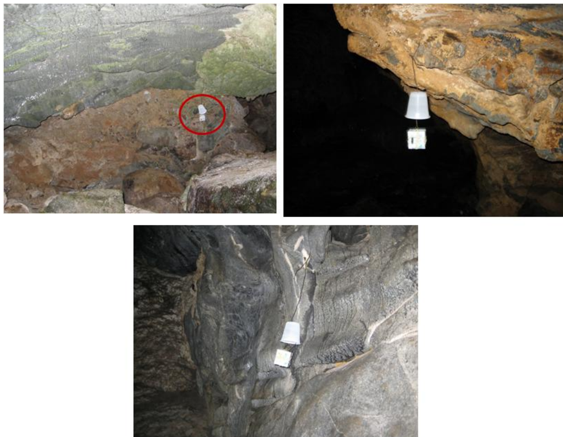
Figura 71. Termohigrômetros instalados na gruta do Minotauro
