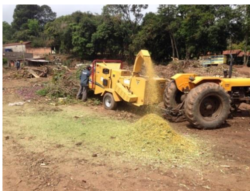
Figura 22: RV sendo triturados no galpão de moagem (1).
