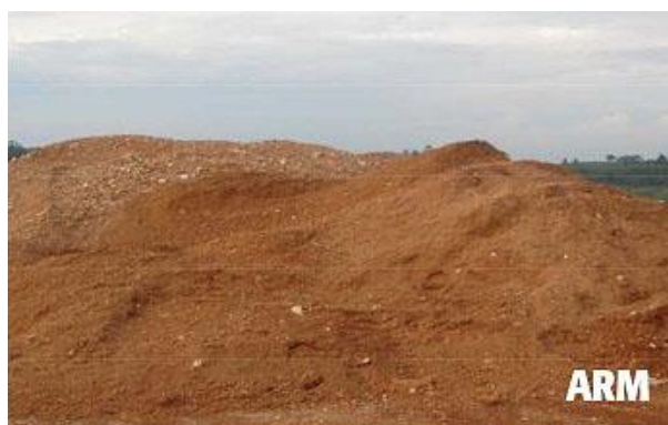
Figura 27: Produto final - Agregado Reciclado Misto tipo Bica Corrida(Fonte: Cemara Pró Ambiental).
