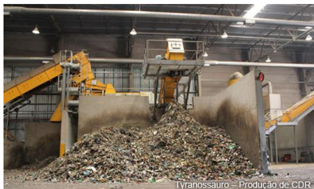
Figura 70: Tyranossauro, equipamento de produção de CDR da Estre Ambiental
