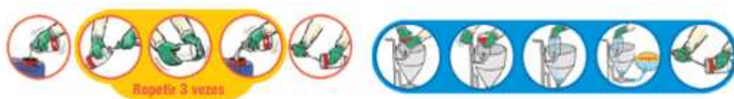
FIGURA: TRÍPLICE LAVAGEM E LAVAGEM PRESSÃO DAS EMBALAGENS DE AGROTÓXICO.
