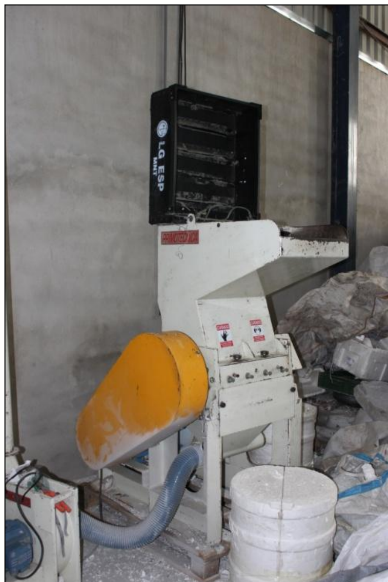
Figura 3.3.3.2.56 - Equipamento utilizado na moagem, compactação, transporte e pesagem do isopor.
