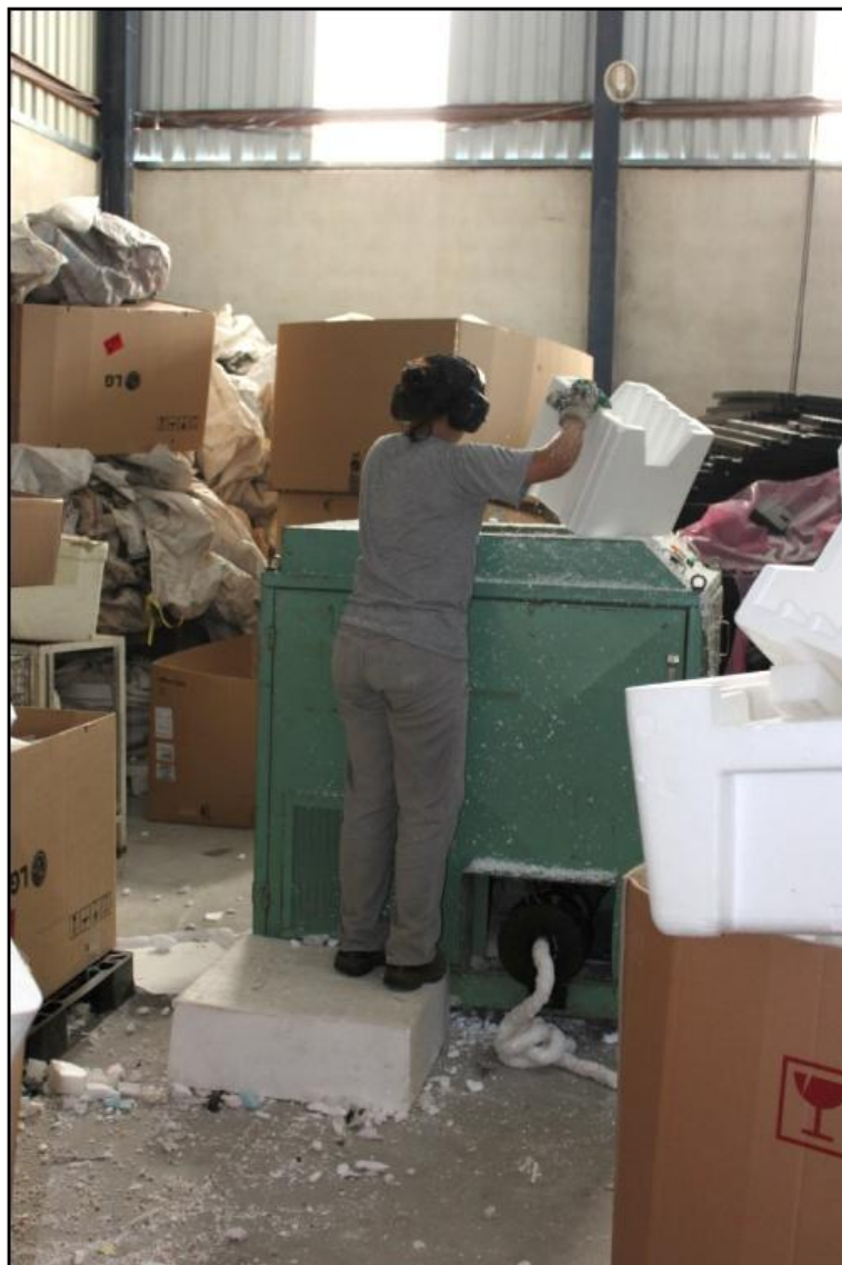
Figura 3.3.3.2.55 - Equipamento utilizado na moagem, compactação, transporte e pesagem do isopor.
