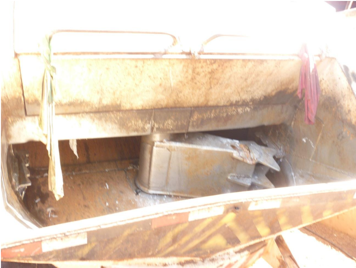
Figura 14 – Detalhe da prensa tipo “leme horizontal” do caminhão reserva
