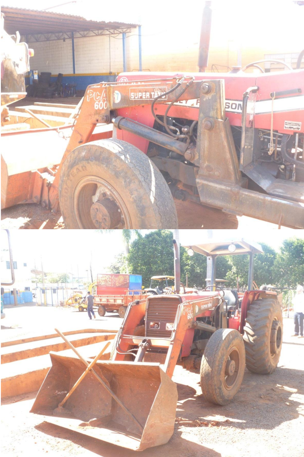
Figura 26 e 27 – Trator com implemento para a recolha de materiais pesados
