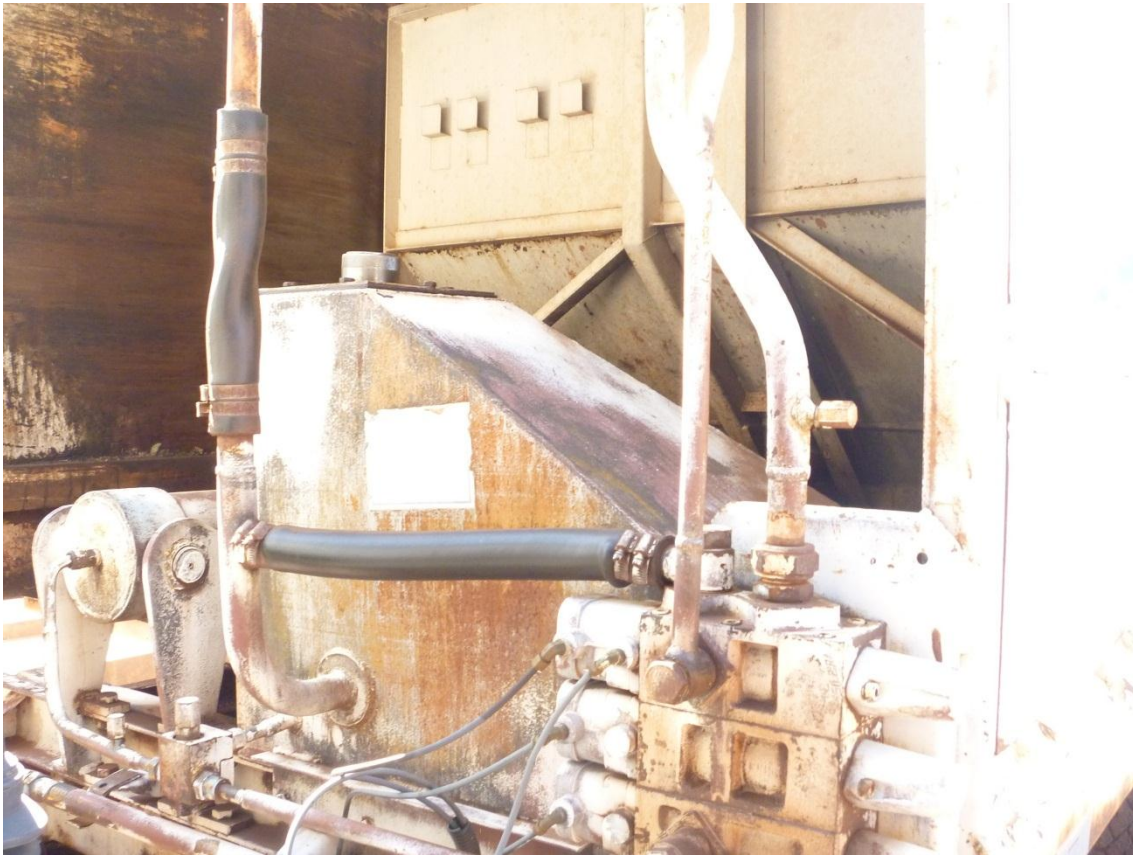
Figura 15 – Detalhe do sistema hidráulico do caminhão reserva.
