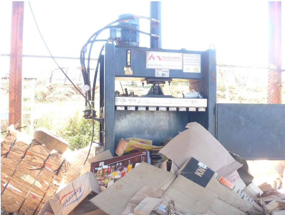
Figura 54 – Prensa vertical para enfardamento de recicláveis.
