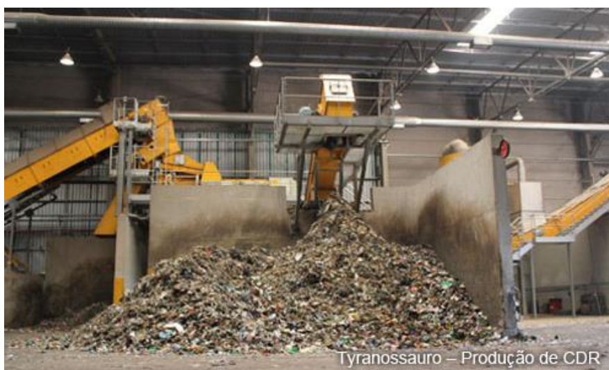
Figura 43. Tyranossauro, equipamento de produção de CDR da Estre Ambiental.
