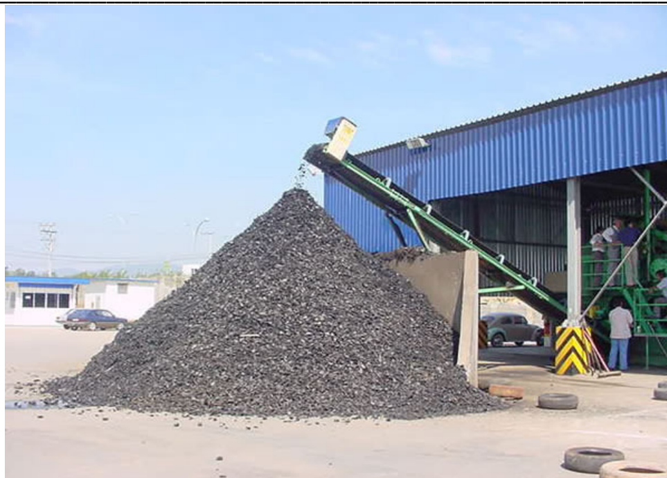
Foto 6.7.2-3 – Borracha triturada dos pneus
