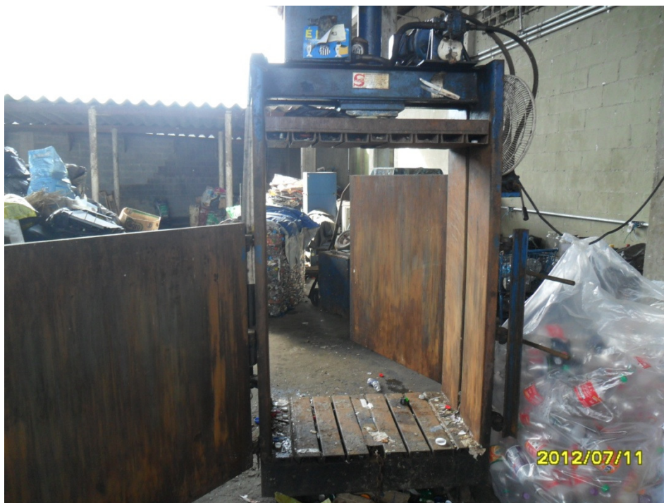
Foto 4.3.5-6 Galpão de triagem – Detalhe da compactadora de papel reciclado
