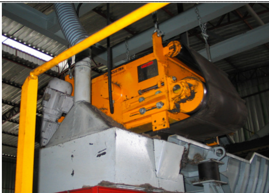
Foto 6.9.2-2 Sistema de separação de metais do RSU domiciliar e de pequeno comércio
