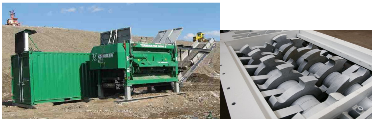
Foto 6.9.2-1 Sistema de trituração de RSU domiciliar e de pequeno comércio
