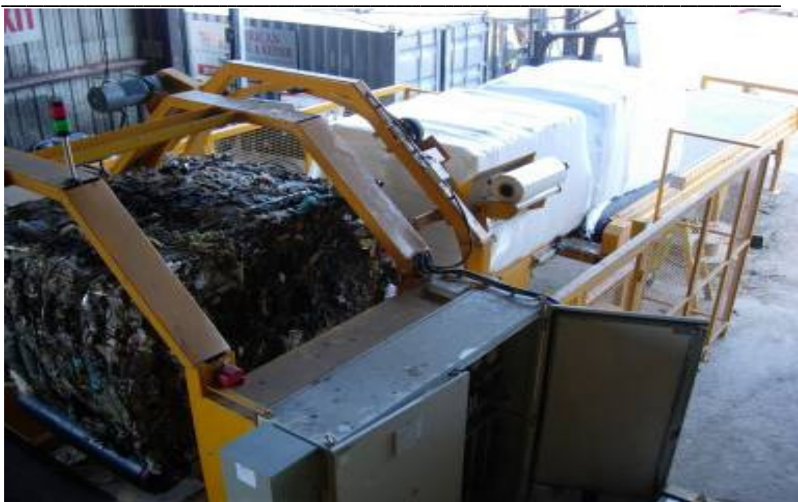
Foto 6.9.2-4 Sistema de enfardamento de CDR (RSU compactado)
