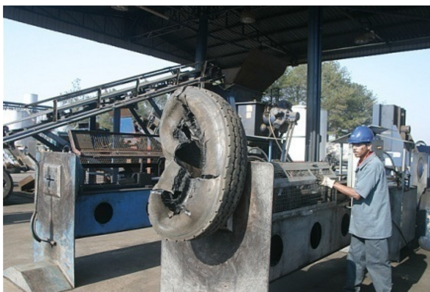
Foto 6.7.2-1- Extrator de aço, antes de triturar
