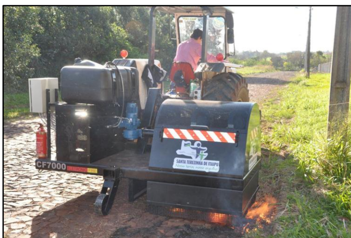
Figura 15: Modelo de capinadeira a fogo.
