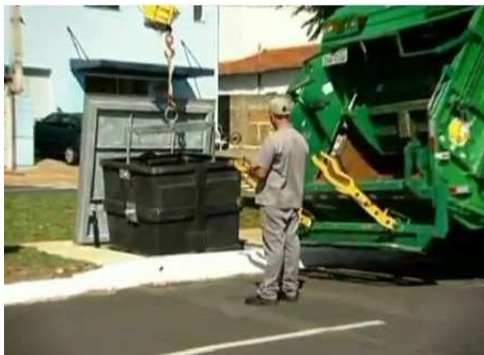
Figuras 10 e 11 — Sistema de coleta e manejo dos containers subterrâneos Fonte: G1.Globo.com, 2010
