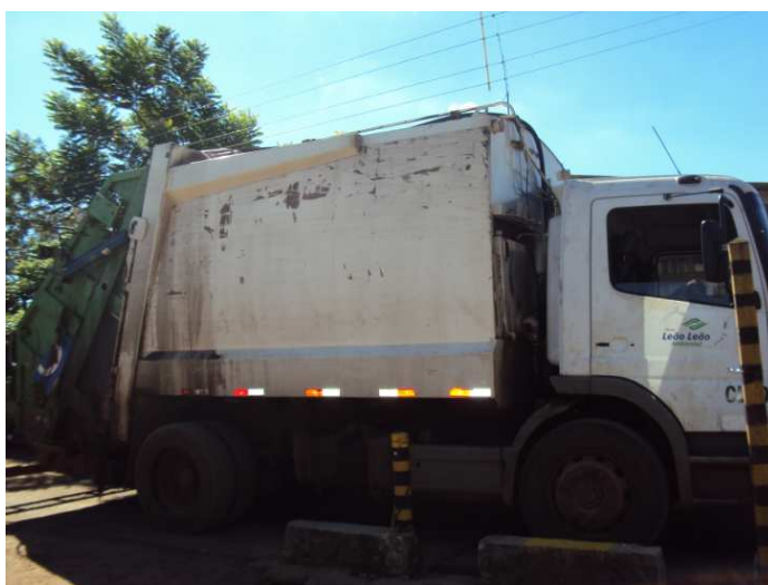
Figura 30 – Caminhão coletor com capacidade de 5m 3 , utilizado no período diurno.
