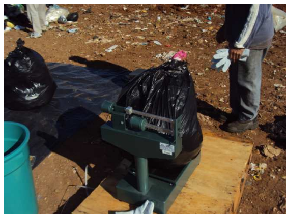
Fig. 42 e 43 – Pesagem do recipiente vazio (tara) e pesagem apenas do volume de material separado
