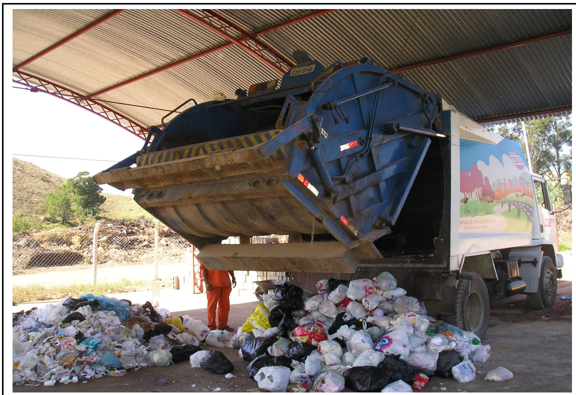
Foto 4.2. - Descarga no pátio coberto de uma amostra de resíduos domiciliares destinados às operações de triagem para determinação da composição gravimétrica.
