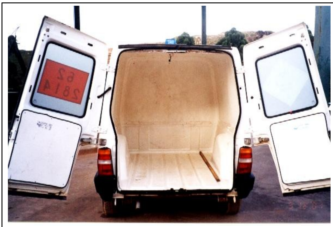
Foto 4.12. – Vista interna do veículo mostrado na Foto 4.11., observando-se o revestimento interno que impermeabiliza a sua carroceria e assim evita o espalhamento de líquidos percolados nas vias públicas.
