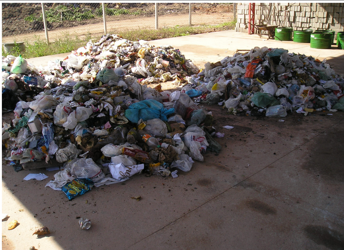
Foto 4.5. - Quarteamento da amostra. Vêm-se os 4 montes separados dos quais foram descartados 2 montes e procedida a mais uma homogeneização e um segundo quarteamento.
