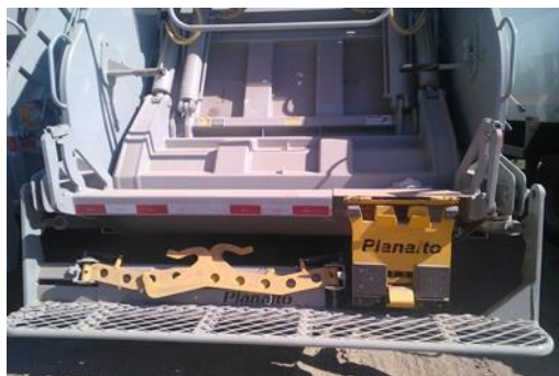
FIGURA 45 – CAMINHÃO COM GUINDASTE PARA COLETA DE CONTÊINERES DE 240 LITROS
