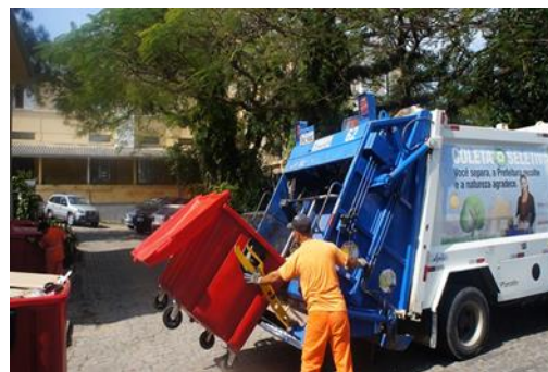
FIGURA 46 – CAMINHÃO COM GUINDASTE PARA COLETA DE CONTÊINERES DE 1.000 LITROS
