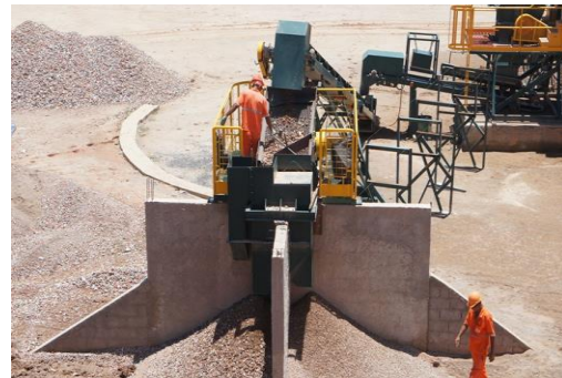
FIGURA 83 – TRITURADOR DE RESÍDUOS INERTES EM FUNCIONAMENTO
