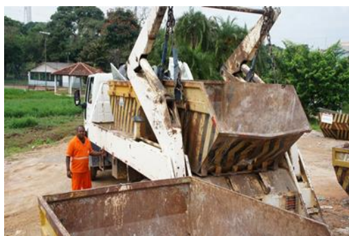
FIGURA 47 – CAMINHÃO COM GUINDASTE PARA COLETAS DE CAÇAMBAS DE AÇO
