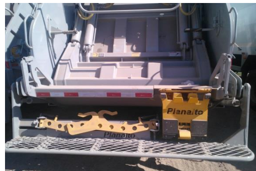
FIGURA 42 – CAMINHÕES COLETORES COMPACTADORES EQUIPADOS COM LIFT
