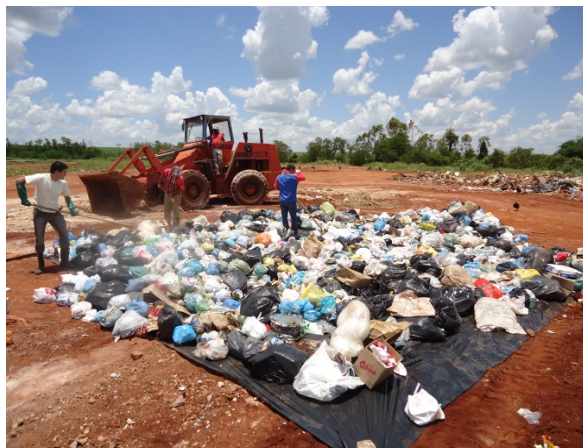
Figura 8.1.8. Resíduos sendo espalhados sobre a lona plástica.
