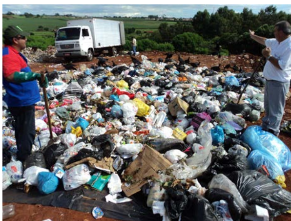
Figura 8.1.32. Orientações para o processo de quarteamento da amostra.
