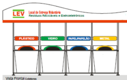
Figura 7 – Esquema de Local de Entrega Voluntária para os novos loteamentos Fonte: Plano Diretor de Resíduos Sólidos de Guarulhos-SP
