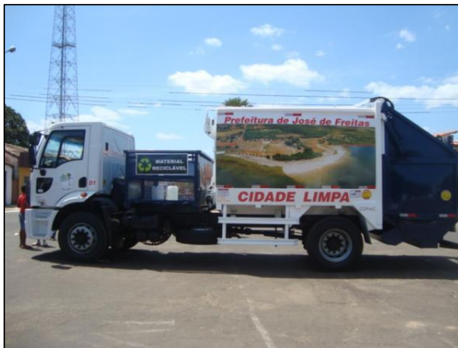
Figura 14: Veículo adequado para coleta de rejeitos e resíduos recicláveis.
