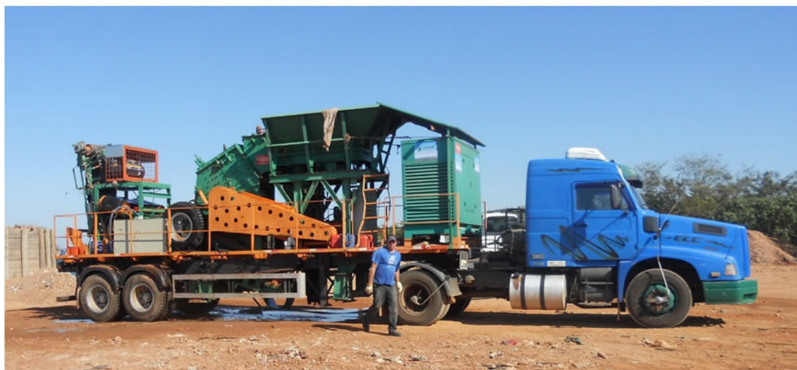
Foto 5.2.6-1 - Equipamento móvel de britagem do CONSAB, utilizado para a reciclagem de resíduos da construção civil nos municípios consorciados.
