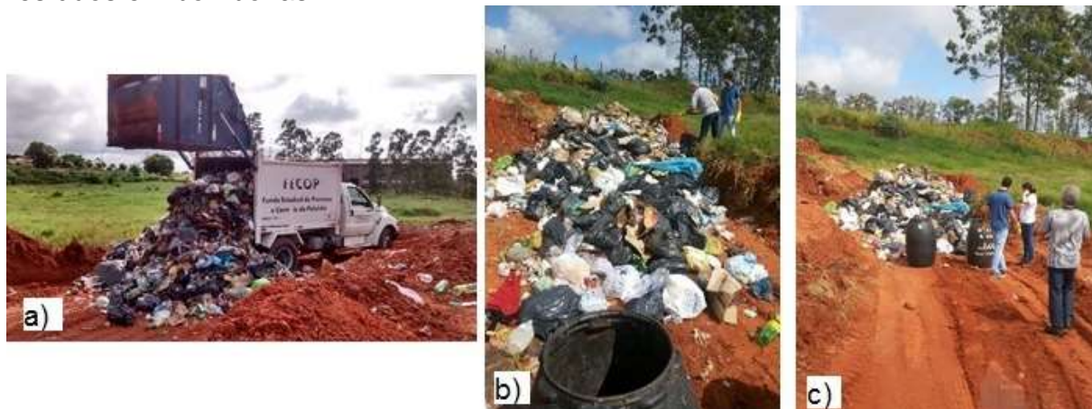
Figura 40 – Método de quarteamento: (a) Descarga dos resíduos pelo veículo coletor; (b) revolvimento da pilha para homogeneização dos resíduos; (c) coleta resíduos em bombonas.
