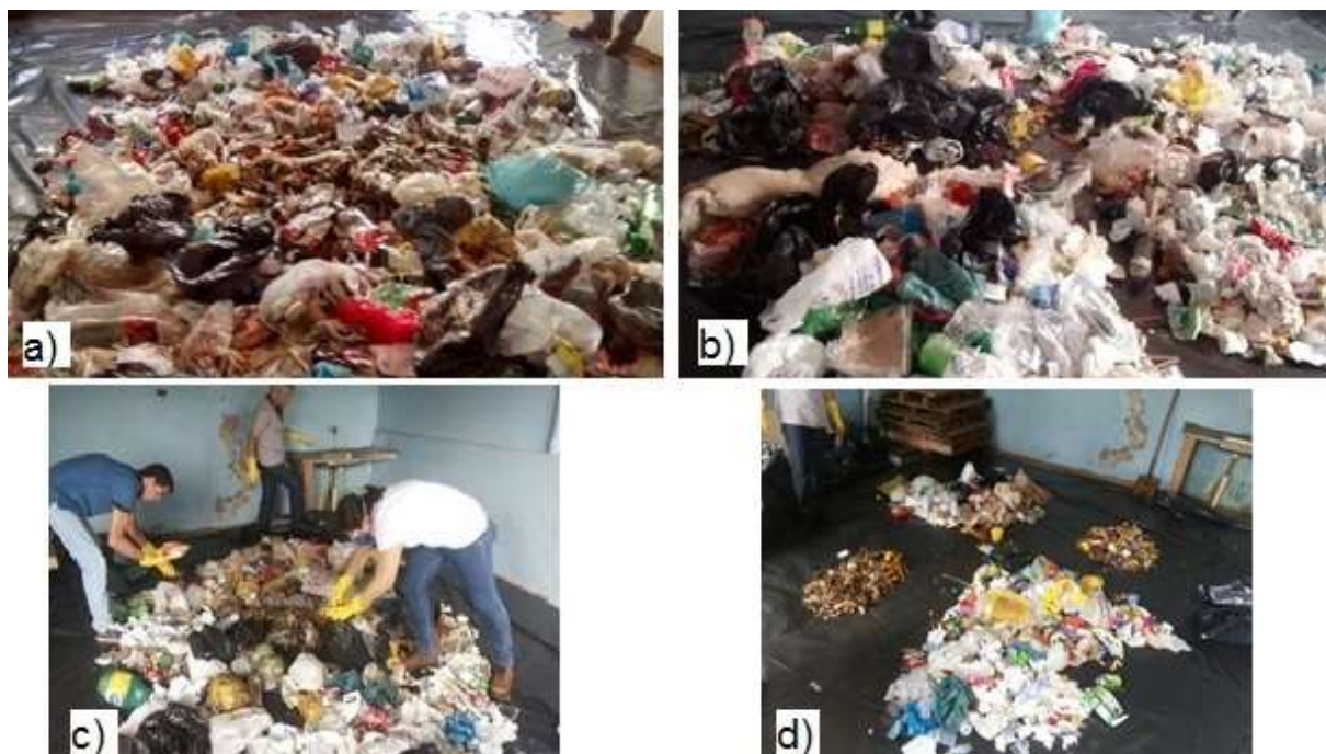
Figura 41 – Método do quarteamento: (a) revolvimento dos resíduos para coleta da amostragem; (b) divisão dos resíduos coletados; (c) e (d) separação em sacos plásticos, por tipo de resíduo.
