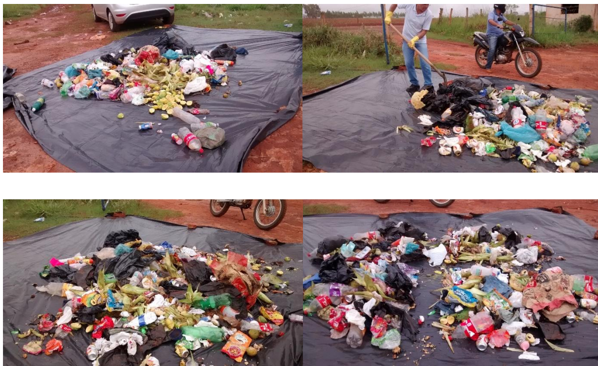
Figura 37 – Método do quarteamento: (a) revolvimento dos resíduos para coleta da amostragem; (b) divisão dos resíduos coletados; (c) e (d) separação em sacos plásticos, por tipo de resíduo.
