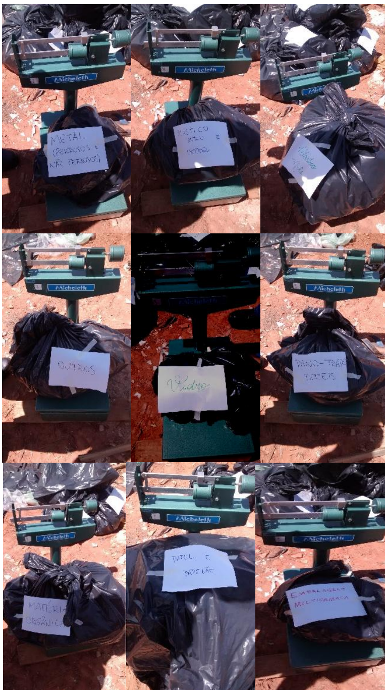
Figura 52 – Método do quaternamento: pesagem dos resíduos, de acordo com o tipo, separado anteriormente.
