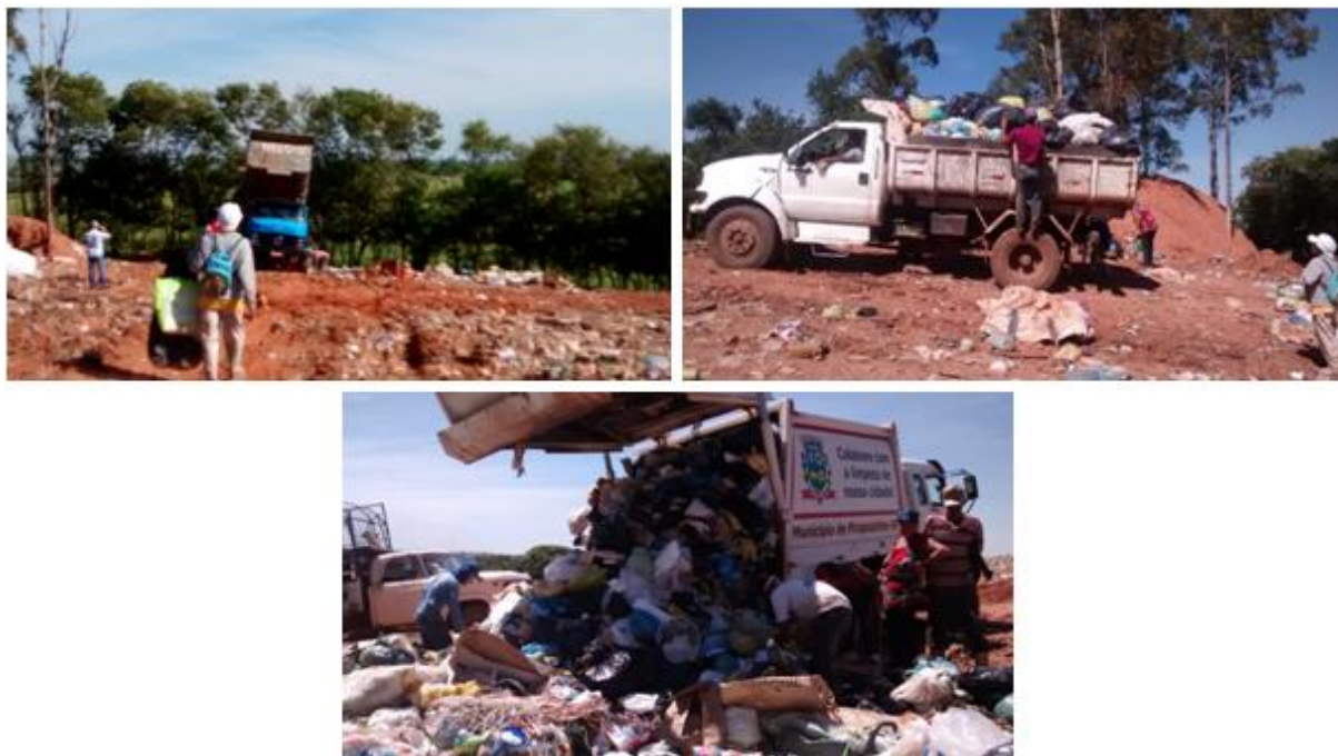
Figura 44 – Método de quaternamento: Descarga dos resíduos pelos veículos coletores.
