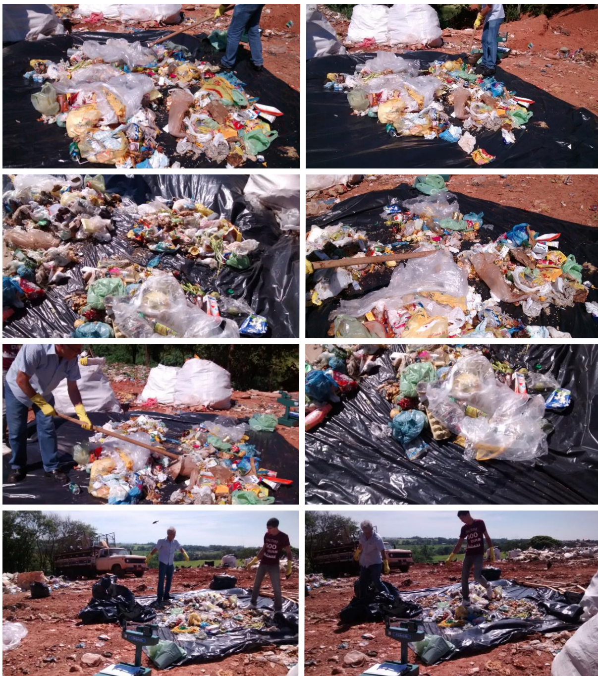
Figura 45 – Método do quaternamento: (a) revolvimento dos resíduos para coleta da amostragem; (b) divisão dos resíduos coletados; (c) e (d) separação em sacos plásticos, por tipo de resíduo.
