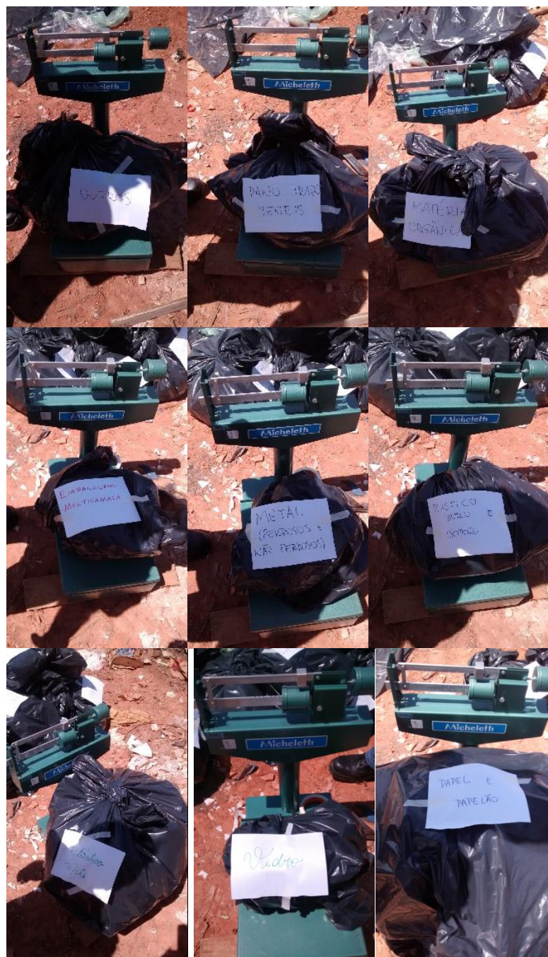
Figura 46 – Método do quaternamento: pesagem resíduos, de acordo com o tipo, separado anteriormente. (Pq. Residencial Natal Marrafon)
