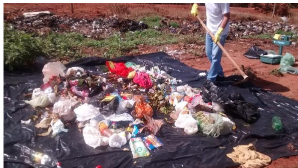
Figura 55 – Método do quaternamento: (a) revolvimento dos resíduos para coleta da amostragem; (b) divisão dos resíduos coletados; (c) separação em sacos plásticos, por tipo de resíduo.
