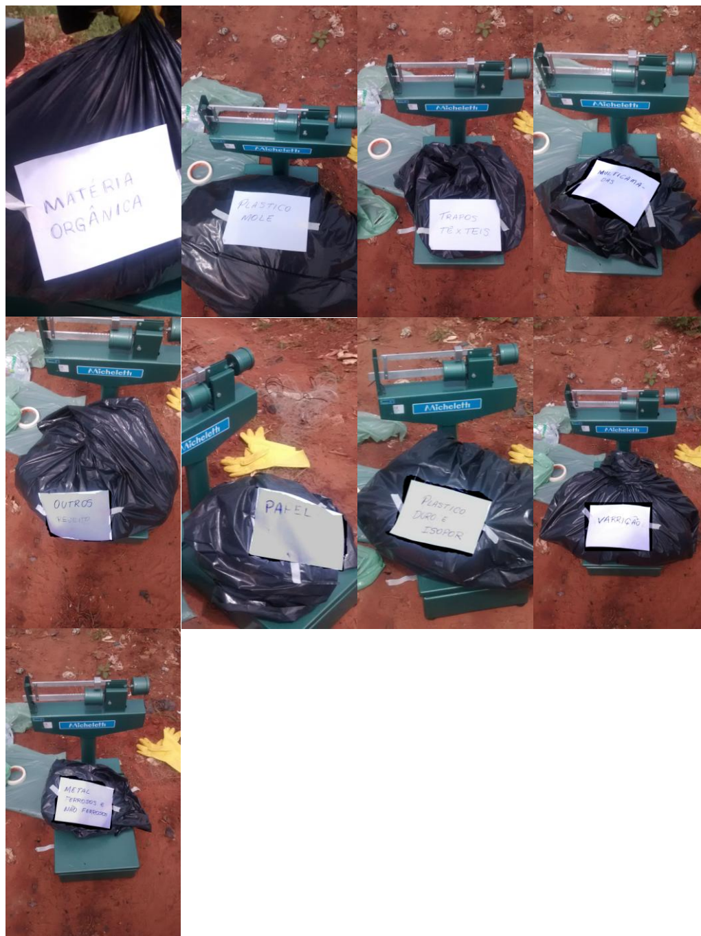
Figura 56 – Método do quaternamento: pesagem dos resíduos, de acordo com o tipo, separado anteriormente.
