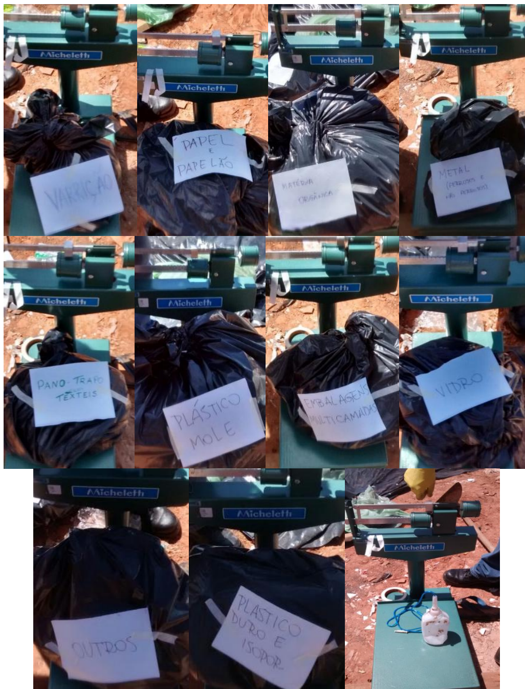
Figura 49 – Método do quaternamento: pesagem dos resíduos, de acordo com o tipo separado anteriormente.
