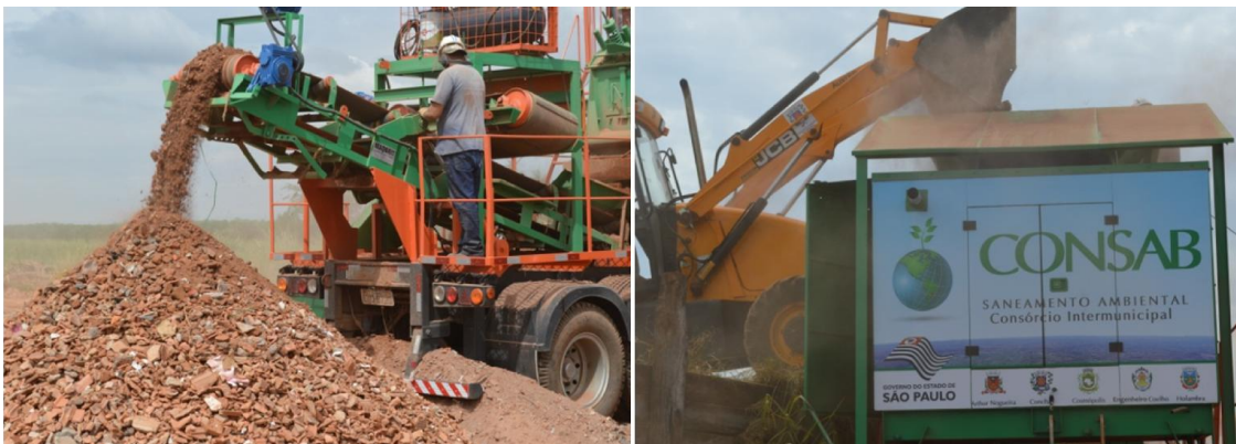
Fotos 5.2.6-2 e 5.2.6-3 - Detalhes do equipamento móvel de britagem do CONSAB.
