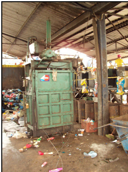
Foto 18 - Prensa hidráulica utilizada na compactação de recicláveis (fardos).
