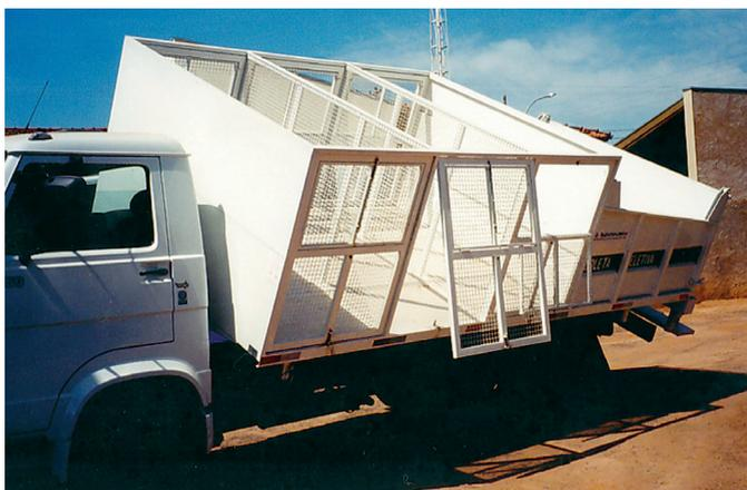
**FIGURA 8** - VEÍCULO MISTO PARA COLETA REGULAR E SELETIVA.
