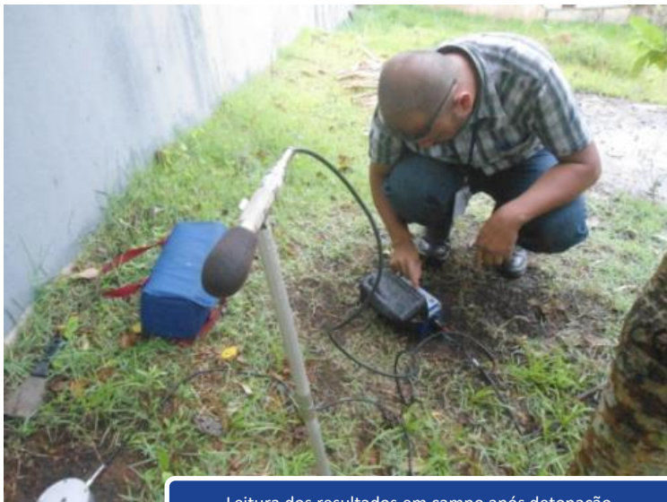
Leitura dos resultados em campo após detonação
