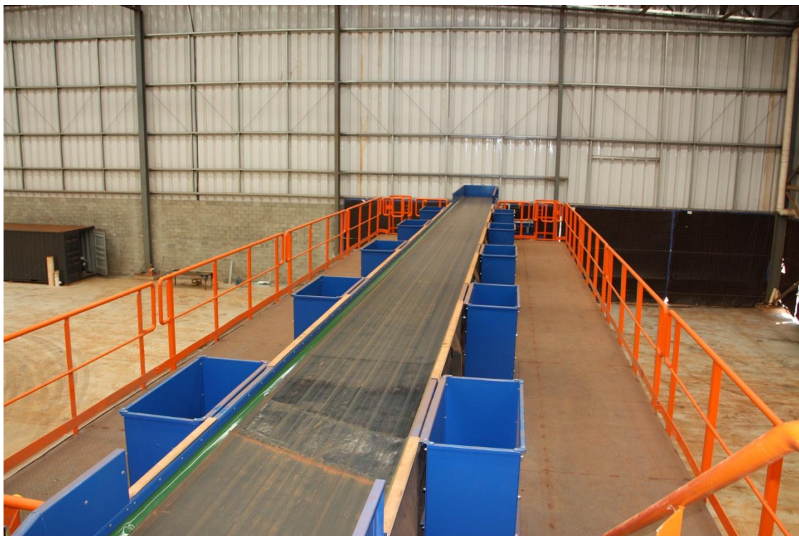
Figura 9: Bancada de triagem manual, que consiste na última etapa da triagem.
