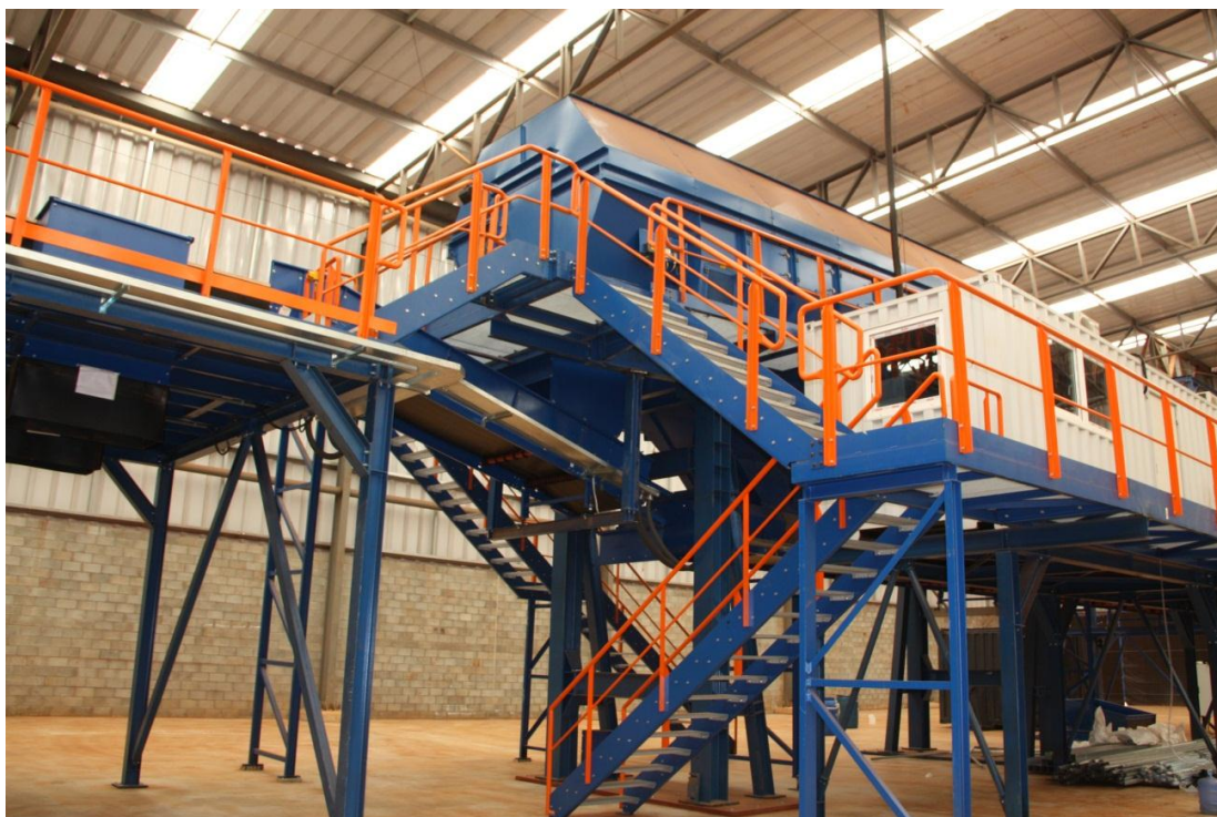
Figura 8: Maquinários utilizados na triagem dos resíduos, que conta com imã para separação dos metais ferroso, com as peneiras de diferentes tamanhos e, por fim, pela bancada de triagem manual.
