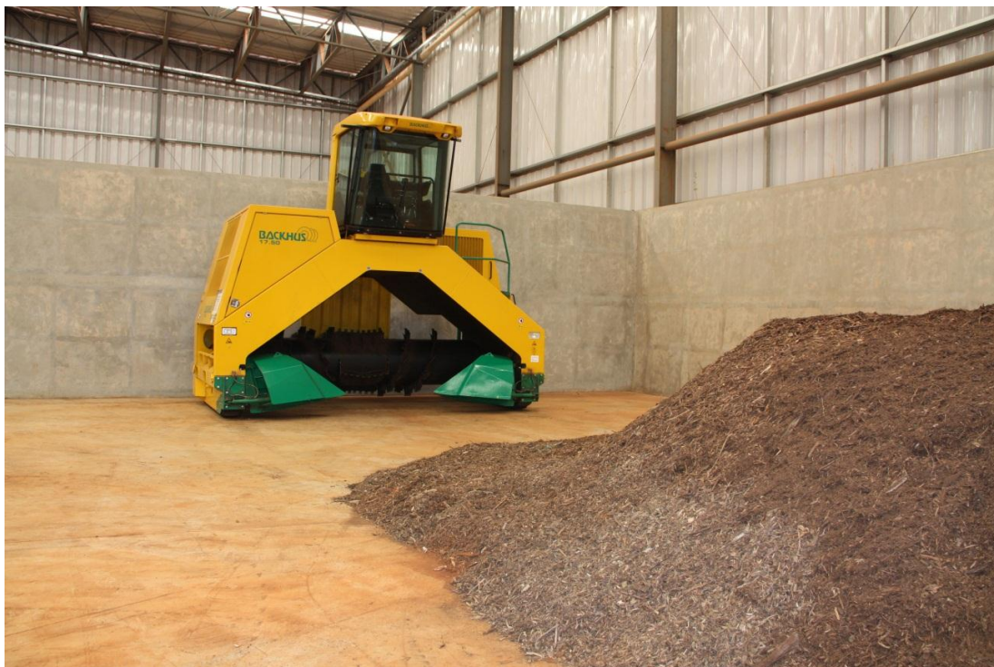
Figura 7: Máquina que revolve as leiras de compostagem. Na foto há uma leira para demonstração do equipamento.
