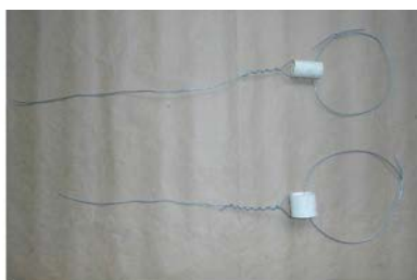
Tubo plástico "PVC" usado como isoladores de partida
