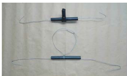
Mangueiras plásticas como isoladores de linha
