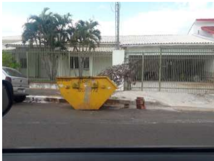
Foto 67. Condições da caçamba utilizada pela empresa Bovo (ausência de faixa refletivas)
