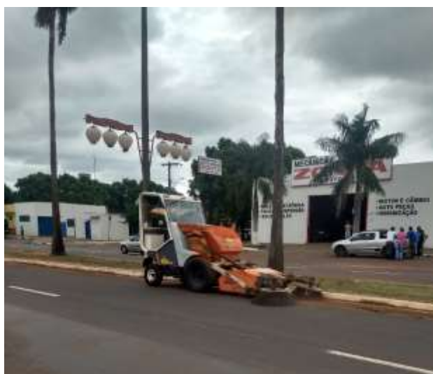
Foto 61. Varredeira AUSA utilizada para varrição mecanizada
