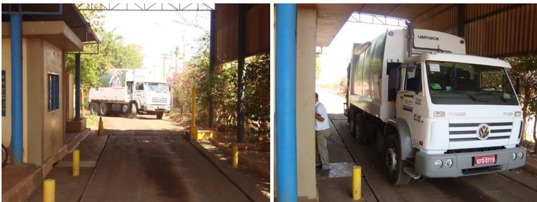
Figura 16: Pesagem do caminhão coletor na chegada a Área de Transbordo. Fonte: DAEMA, 2011.
