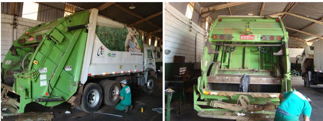
Figura 6: Funcionário da Leão Ambiental S/A realizando manutenção no caminhão coletor. Fonte: DAEMA, 2011.
