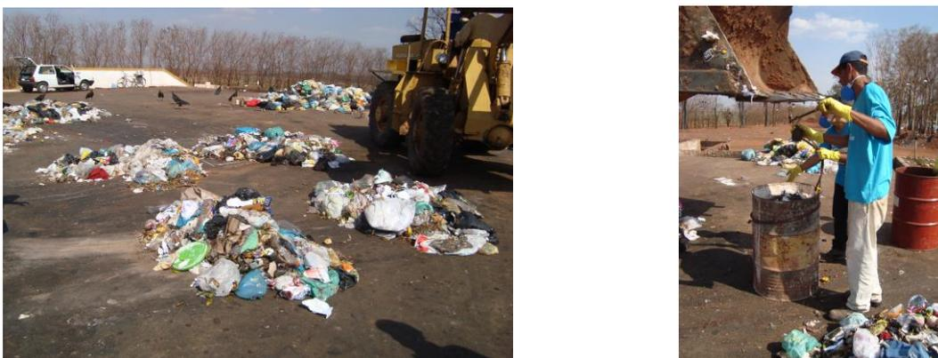
Figura 39: Quarteamento da amostra, descartando duas partes e pesando as restantes. Fonte: DAEMA, 2011.
