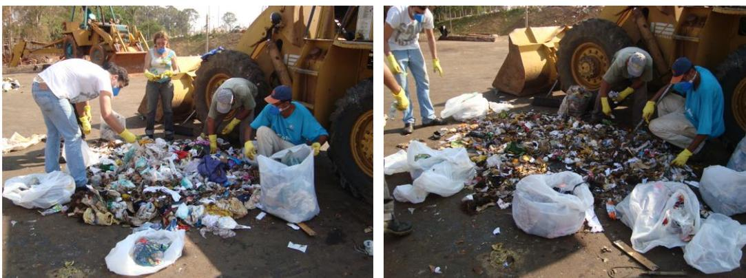
Figura 40: Separação dos materiais da amostra para a composição gravimétrica. Fonte: DAEMA, 2011.
