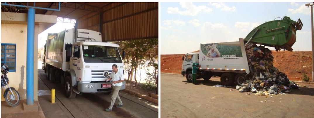
Figura 30: Pesagem do Caminhão Coletor e descarregamento para amostragem. Fonte: DAEMA, 2011.
