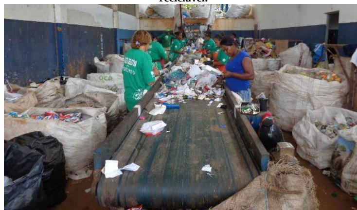
Figura 17 – Esteira transportadora onde é feita a separação do material reciclável.
