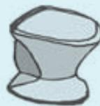
**Bacia sanitária (5% a 14%)** – As fabricadas a partir de 2003 gastam 6 litros por acionamento, mas as antigas gastam a partir de 9 litros.
