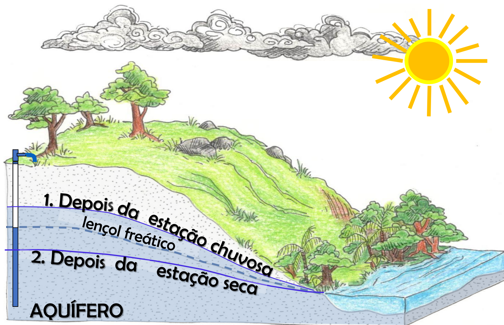
Figura 7. A profundidade do lençol freático oscila ao longo do ano em vista da variação da quantidade de chuva. A linha tracejada representa a profundidade média do lençol; essa é a profundidade representada no poço. A linha 1 é a que acontece depois de haver muita infiltração da água da chuva no solo, durante a estação chuvosa, causando a recarga . Ao final dessa estação, o lençol freático estará mais raso. A linha 2 é a que acontece depois da estação seca; o lençol freático rebaixa porque na estação seca as chuvas são escassas e não há infiltração.
