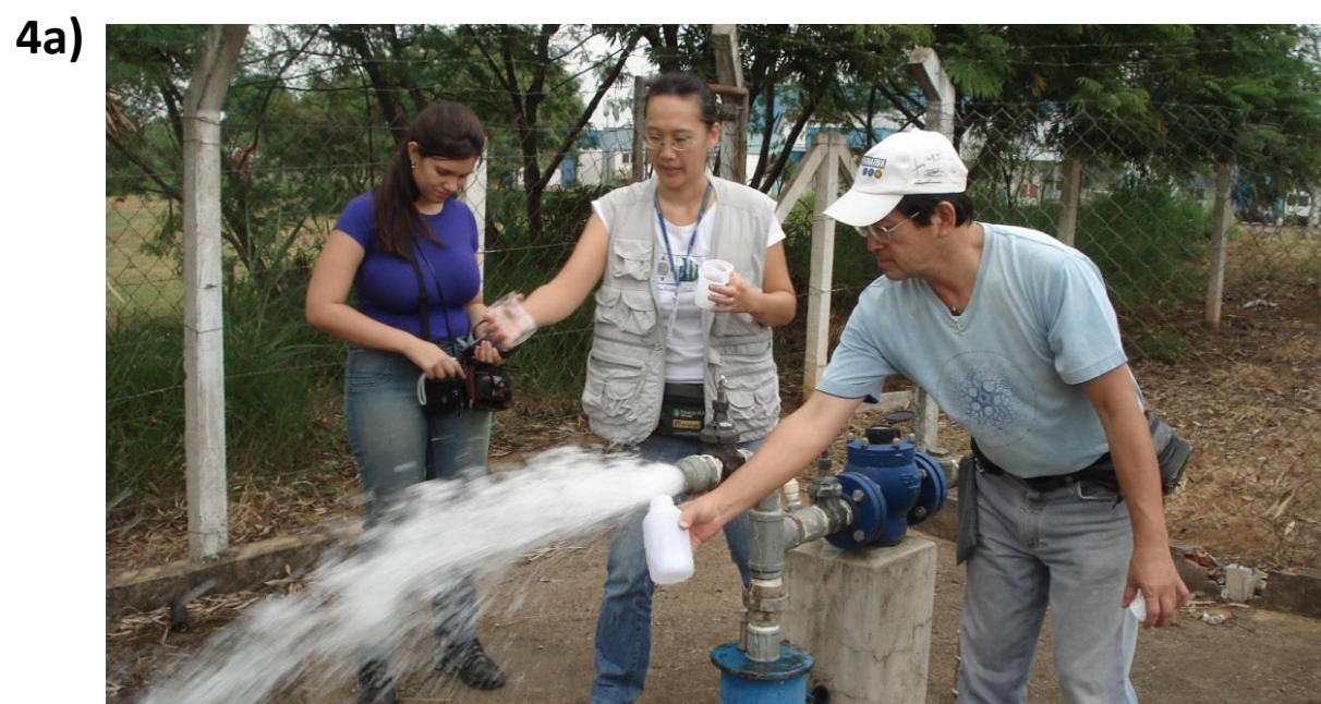
Figura 4. Aquíferos são formações geológicas capazes de armazenar e transmitir água através de seus poros (ver figuras 3, 10, 11) em quantidades que possam ser aproveitadas como fonte de abastecimento para diferentes usos. Portanto os poços perfurados em aquíferos, ao contrário dos aquitardes e aquicludes, são capazes de fornecer água em quantidade significativa (4a). No cartum ao lado (parte 4c), vemos as gotas de água serem puxadas para o poço; isto acontece quando o poço está sendo bombeado (4b). A representação em 4c, as partículas sólidas parecem boiar na água, mas na verdade essas partículas encostam umas nas outras.
