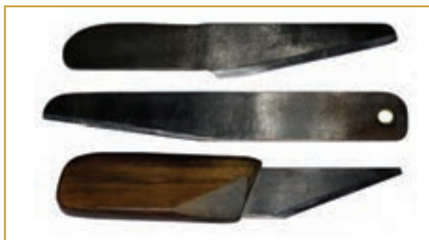
Figura 6. Faca para polimento da superfície da madeira, para exame macroscópico.
