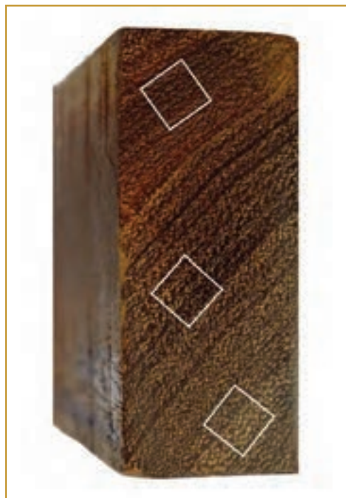
Figura 11. Amostra de madeira com os quadrados corretamente posicionados para obtenção de fotos.
