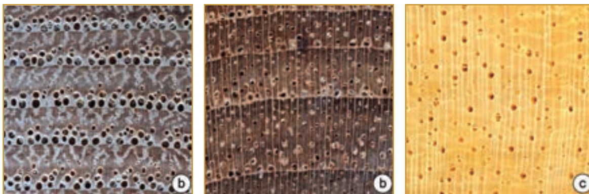
Figura 36. Camadas de crescimento (TR). a. Demarcadas por anel poroso – Castanea crenata . b. Demarcadas por anel semiporoso – Tectona grandis . c. Indistintas – Simarouba amara .
