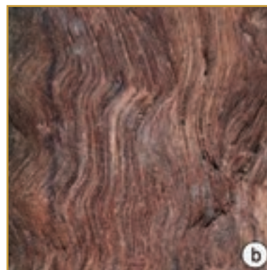
Figura 54. Tipo de grã – plano longitudinal. a. Grã direita - Cordia americana ; b. Grã ondulada – Eucalyptus sp.
