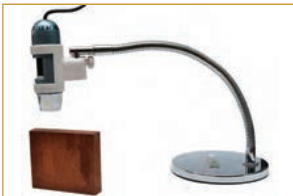
Figura 12. Posição correta do microscópio eletrônico portátil sobre a amostra.
