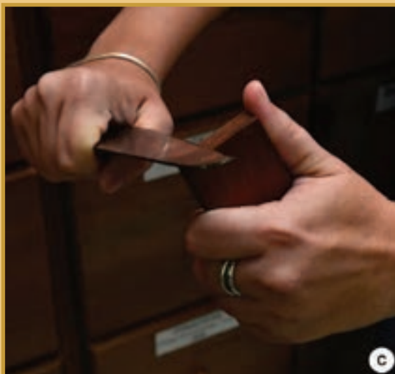
Figura 8. Corte com faca e lâmina de barbear. Como não cortar: c. Não puxar a faca em direção ao peito e manter o dedo acima da linha do corte; d. Manter o dedo abaixo da linha do corte.
