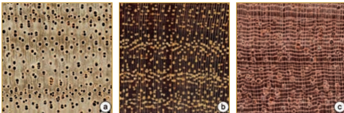
Figura 27. Obstrução de vasos (Tr). a. Vasos desobstruídos – Nectandra oppositifolia . b. Depósitos – Handroanthus sp. c. Tilos – Bertholletia excelsa .
