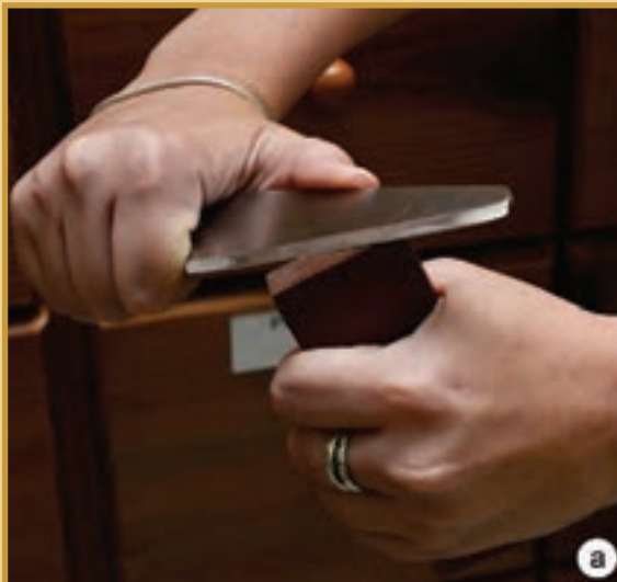
Figure 8. Corte com faca e lâmina de barbear. a. Cortar para fora. b. Corte refinado puxando a lâmina em direção ao peito.
