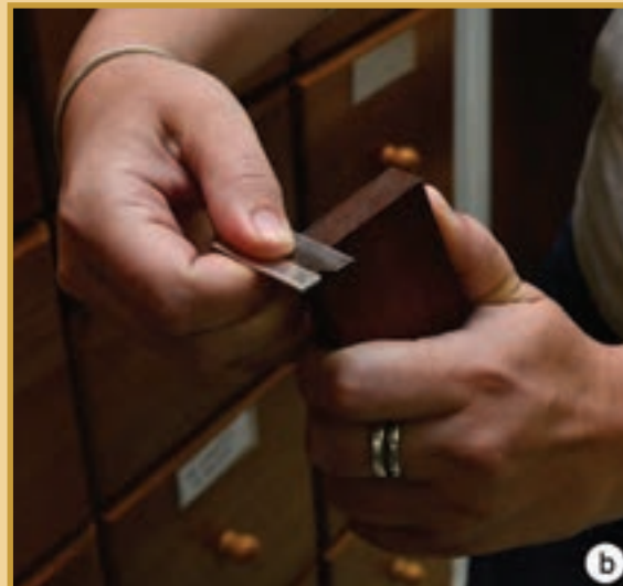
Figure 8. Corte com faca e lâmina de barbear. a. Cortar para fora. b. Corte refinado puxando a lâmina em direção ao peito.
