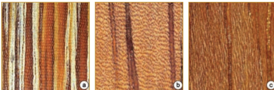
Figura 33. Estratificação (Tg). a. Regular – Sweetia fruticosa . b. Irregular – Cedrelinga cateniformis . c. Não estratificado – Bertholletia excelsa .
