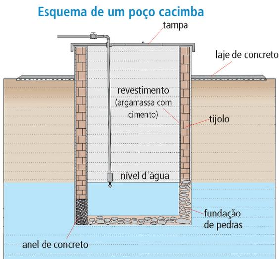
massa de cimento. A parede deve ser erguida alguns centímetros acima do solo e uma laje de concreto deve ser construída ao seu redor. A impermeabilização da parede do poço até os primeiros metros de profundidade e a laje de proteção evitam infiltração de água suja ou poluída que contaminam a água subterrânea. Além disso, o poço deve permanecer sempre tampado e seu entorno cercado para evitar a circulação de pessoas e animais.
