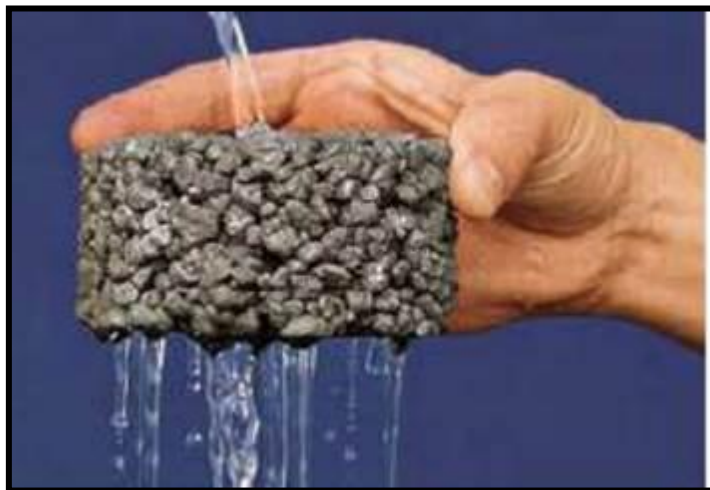
Figura 20 - Dispositivo de controle de escoamento – Pavimento poroso
