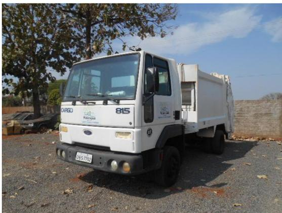
FOTO DO CAMINHÃO COLETOR-COMPACTADOR
