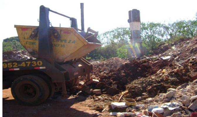
**Figura 5: Caminhão com o entulho da construção civil**
