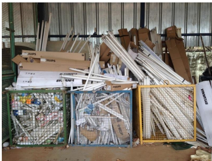
Figura 44: Segregação e armazenamento de lâmpadas fluorescentes.
