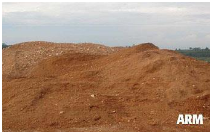
Figura 27: Produto final - Agregado Reciclado Misto tipo Bica Corrida.
