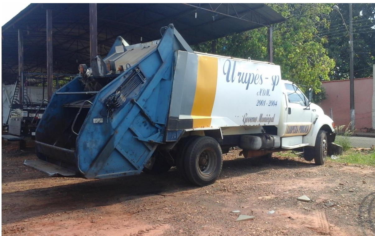
Imagem 73 – Caminhão compactador F 12.000 usado para a coleta dos resíduos domiciliares
