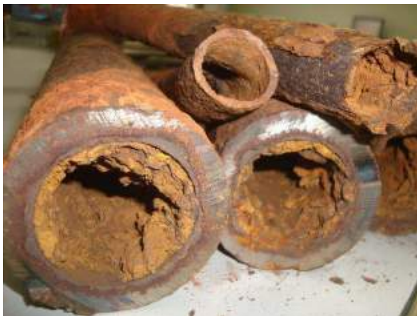
Figura 17- Tubulações de ferro fundido retiradas da região central
