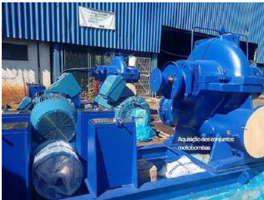
Figura 12 - Novos Conjuntos Moto Bomba
