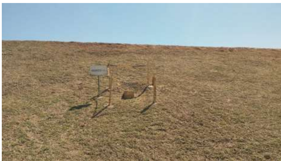
Figura 54 - Controles com marcos de deslocamento. Fonte: CSO Ambiental, 2019.
