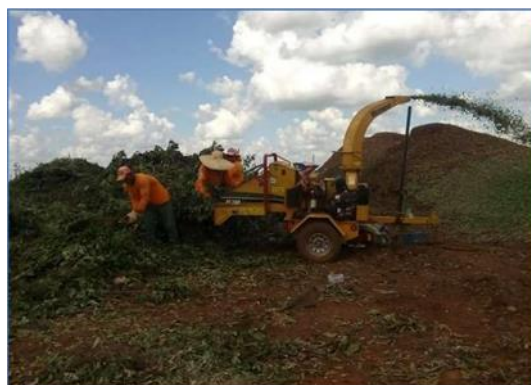
Figura 215 - Central de massa verde e picador de galhos Fonte: PIMRS, 2019.
