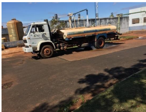
Figura 57 - Caminhão pipa sendo abastecido com água tratada
