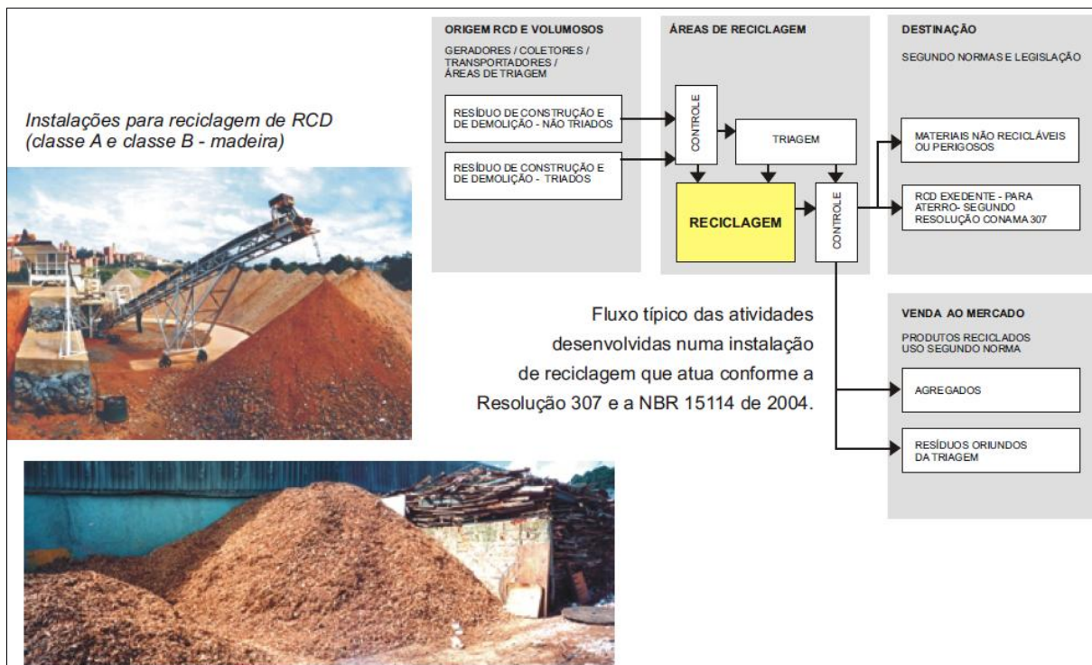
Figura 8 – Fluxograma simplificado de reciclagem de resíduos da construção.
