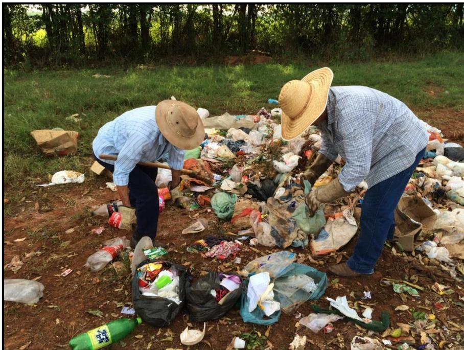
Figura 76 – Sacos plásticos sendo rasgados pelos colaboradores para compor a amostra.
