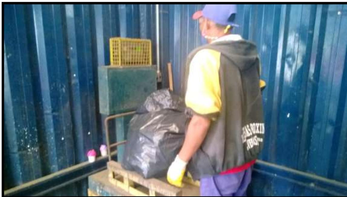
Imagem 49 - Pesagem dos resíduos para o ensaio de composição gravimétrica
