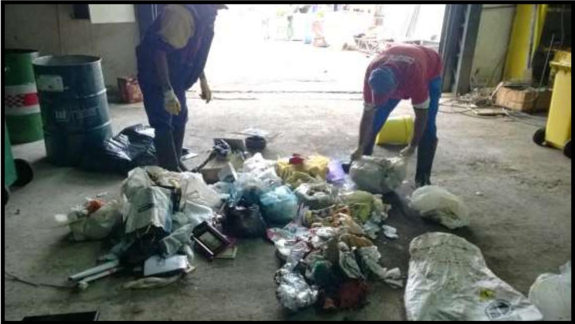
Imagem 47 - Separação dos resíduos para realização do ensaio de composição gravimétrica
