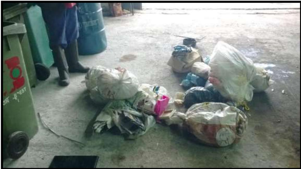
Imagem 46 - Separação dos resíduos para realização do ensaio de composição gravimétrica
