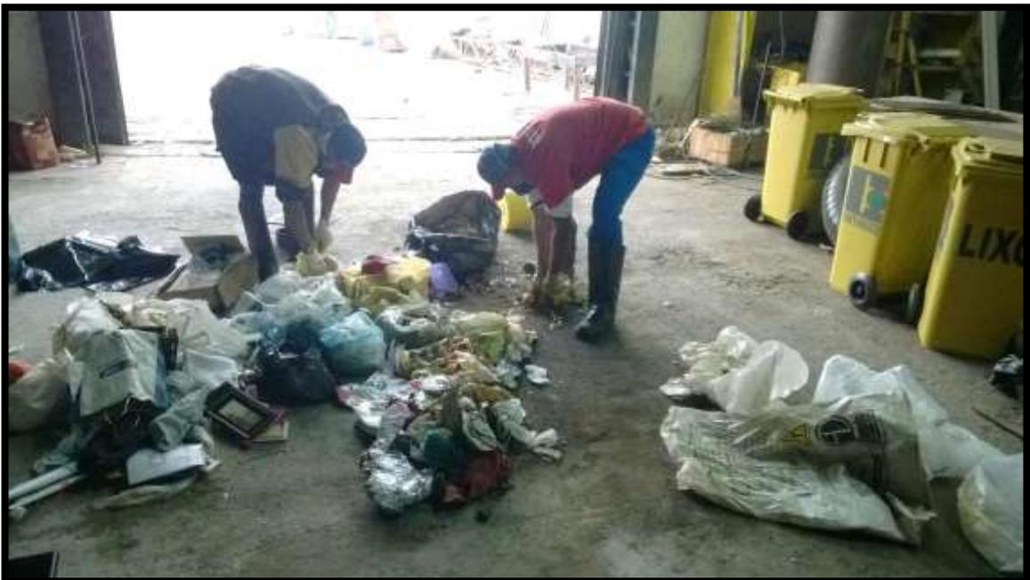
Imagem 48 - Separação dos resíduos para realização do ensaio de composição gravimétrica
