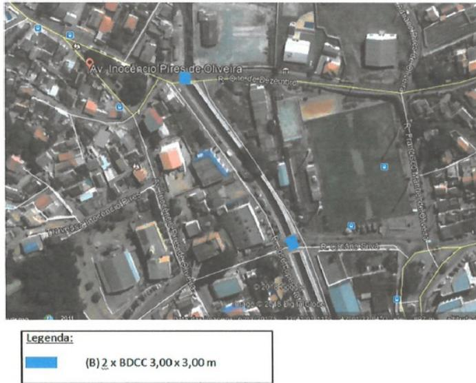
**Ilustração 8.31 – Esquema da solução proposta para o Ponto 11**
