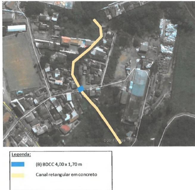
**Ilustração 8.40 – Esquema da solução proposta para o Ponto 14**
