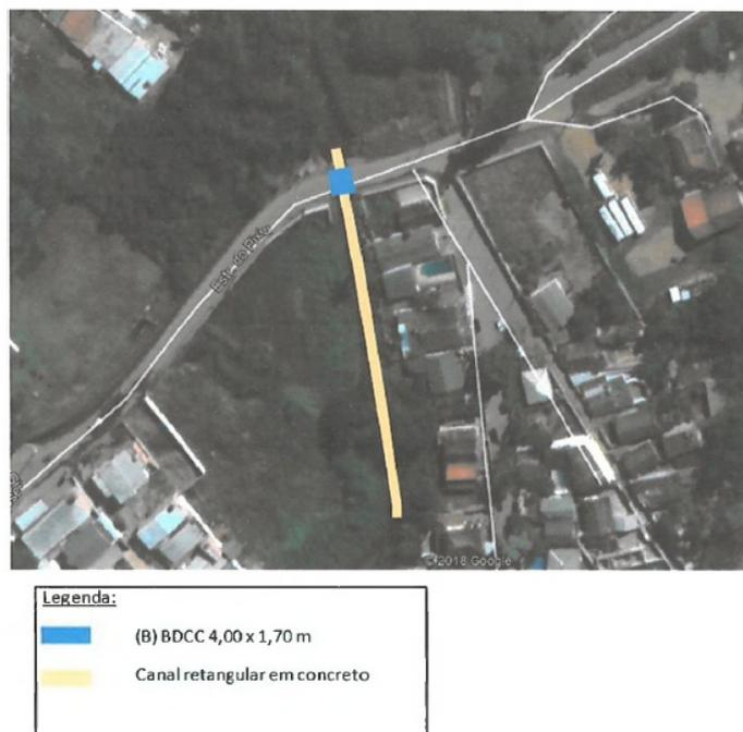
**Ilustração 8.44 – Esquema da solução proposta para o Ponto 15**
