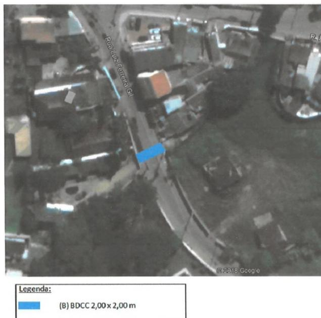
**Ilustração 8.34 – Esquema da solução proposta para o Ponto 12**
