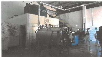
Foto 3.4 - Autoclave para esterilização dos RSS
