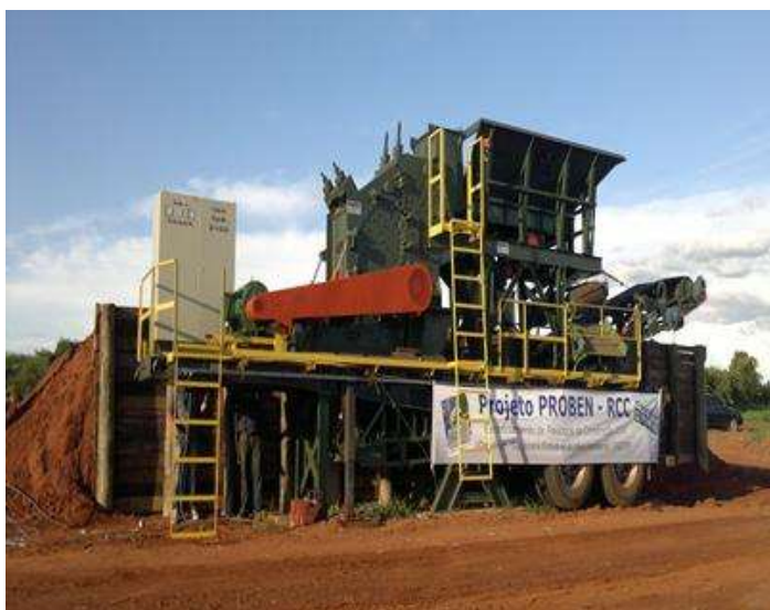
FIGURA 08: Equipamento de beneficiamento de resíduos da construção civil.
