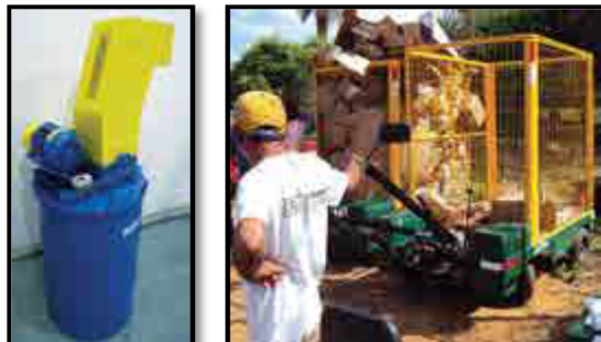
Figura 36. Picotador de vidro e carrinho elétrico respectivamente
