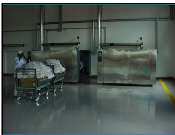
Figura 38. Exemplo de sistema de Autoclave
