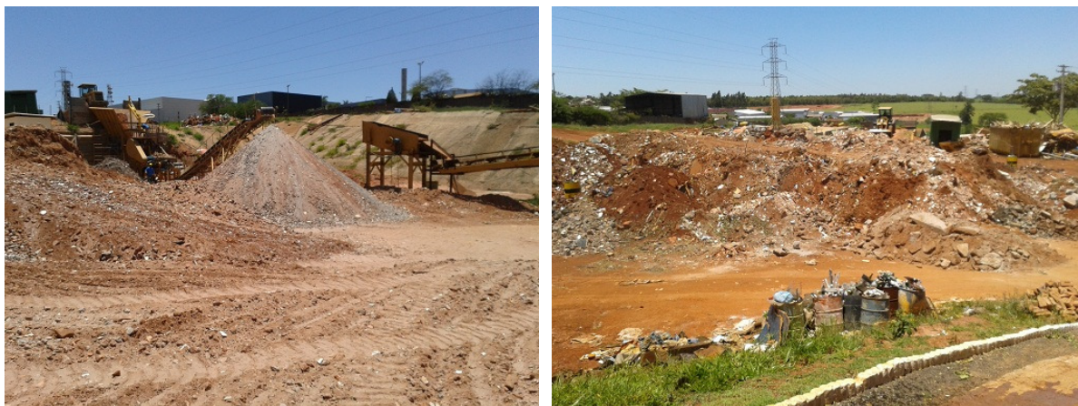
Figura 18. Britador e área de triagem da Usina de Britagem particular
